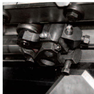
▲ Optimierter Meißelzug für geringste Längentoleranzen
