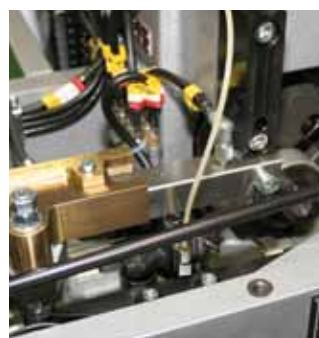
▲ Alimentación de precisión del alambre con cincel de mando mecánico
