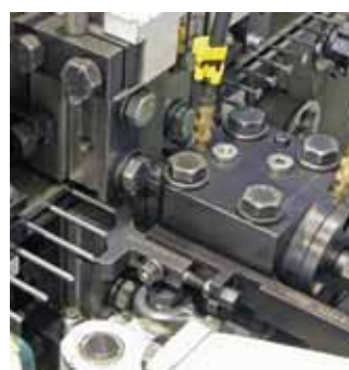
▲ Fijación de la pieza bruta del clavo de alambre con mordazas de presión y recalado de la cabeza del clavo
