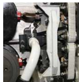
▲ Aguzado de la punta del clavo y aspiración de la chatarra de la punta
